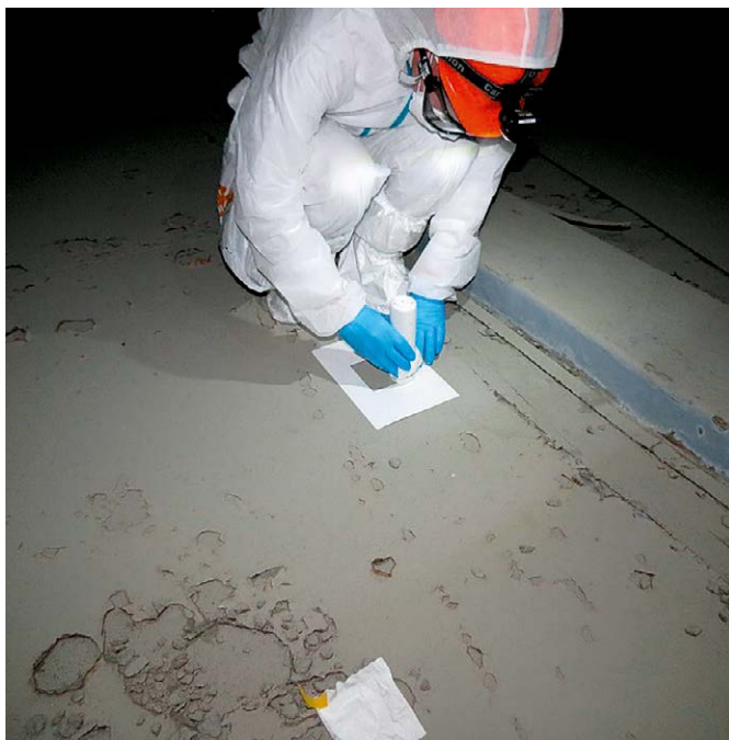
Рис. 3. Відбір проби нефіксованого ПЗ із поверхні з високим запиленням за допомогою автономного міні-пилососа
