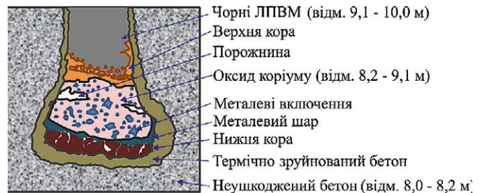
Рис. 3. Результати експериментів VULCANO з дослідження продуктів ВРБ (ЛПВМ — лавоподібні ПВМ)
