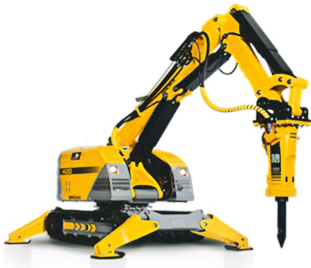
Рис. 4. Загальний вигляд ДКМ на власному ході із пристроєм для швидкого роз'єднання і дистанційної заміни навісного обладнання
