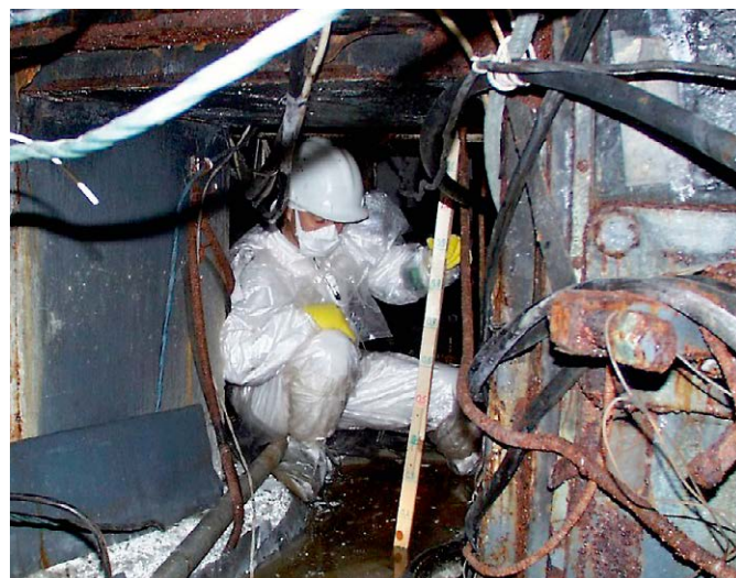
Рис. 2. Дослідження радіоактивно забруднених водних скупчень у приміщенні ОУ
