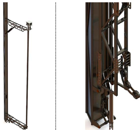
Рис. 6. Тривимірна модель пристрою для вилучення гільз реактора
