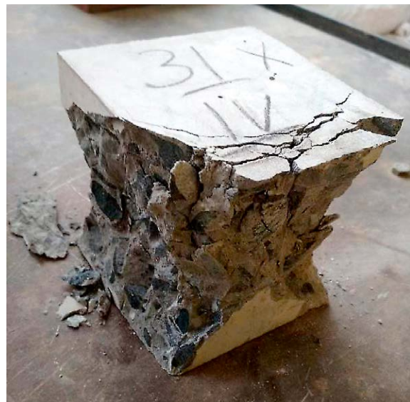
Рис. 8. Випробування радіаційно-захисного бетону на міцність
