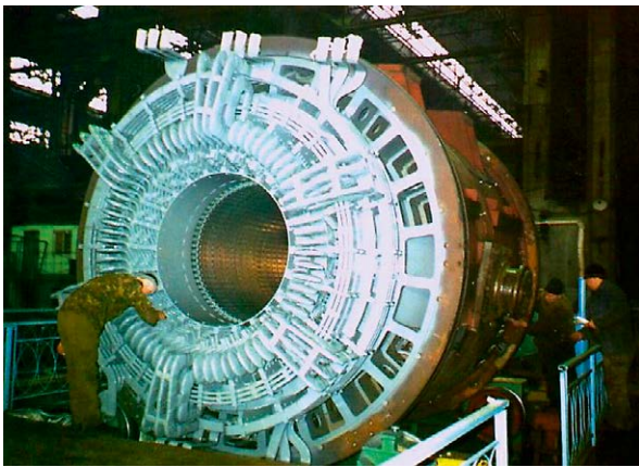
Рис. 3. Головний зразок генератора типу ТА-120
