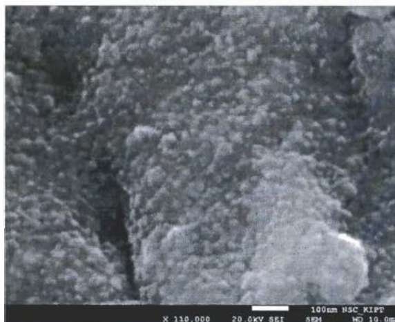
Рис. 8. Поверхность скола слоисто-столбчатого пиролитического карбидохромового покрытия толщиной 18 мкм, полученного при температуре осаждения 500 °С, отношение S/V = 0,08 \text{ см}^{-1} , средняя скорость осаждения — 0,9 мкм/мин, \times 110,000
