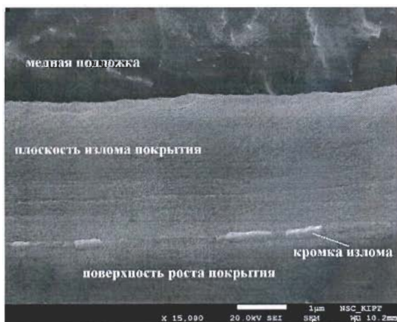
Рис. 4. Появление слоев в покрытии пирохрома, полученного при T_{oc} = 400\text{--}430\text{ }^{\circ}\text{C} на медной подложке
