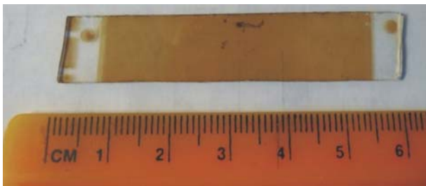
Рис. 15. Фото зразка з покриттям на основі cBN, нанесеного на підкладку із кварцового скла
