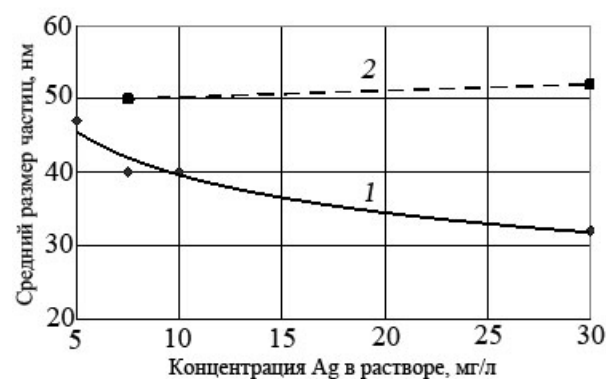
Рис. 7. Зависимость среднего размера частиц в коллоидной системе ПВП–Ag–H 2 O, содержащей 1% ПВП через: 1 – 1 сутки; 2 – 8 суток
