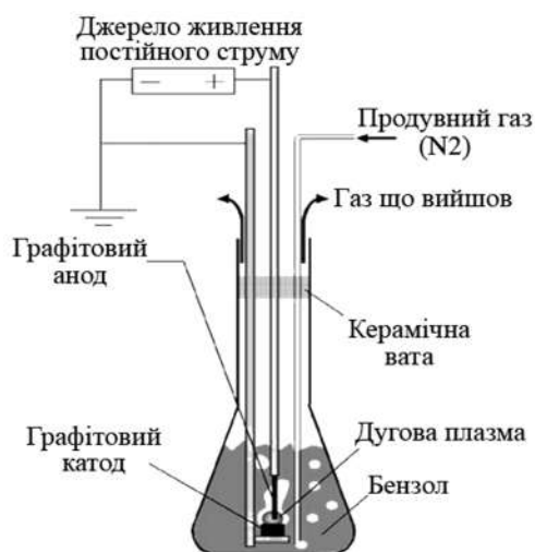
Рис. 7. Установка щодо вивчення зміни кольору органічного робочого розчину при електродуговому синтезі ВНС [60]
