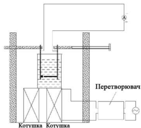
Рис. 11. Схема електродугової установки синтезу в рідкому середовищі з вбудованим поперечним магнітним полем [116]
