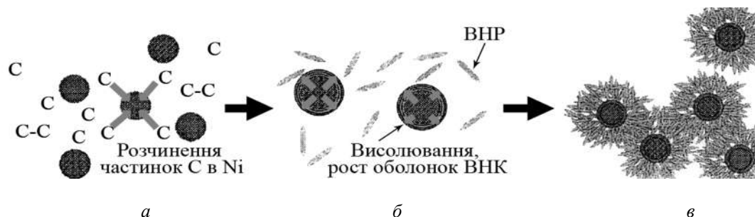
Рис. 4. Схематична модель утворення гібридних частинок ВНР, що включають ВНК, які містять нікель [57]: а – Стадія I – високотемпературна зона, розчинення вуглецю в наночастинці нікелю, вуглецева пара; б – Стадія II – холодна бульбашка газу, утворення ВНК, зародження комплексу; в – Стадія III – швидке загартування продуктів синтезу, синтез комплексу ВНР-ВНК, стабілізований продукт
