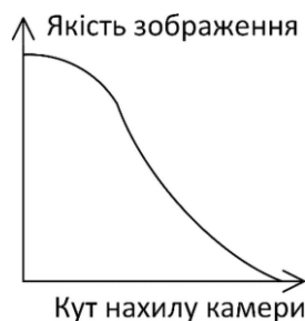
РИС. 4. Залежність якості аерофотозйомки від кута нахилу камери БПЛА щодо вертикалі при фіксованій висоті польоту
