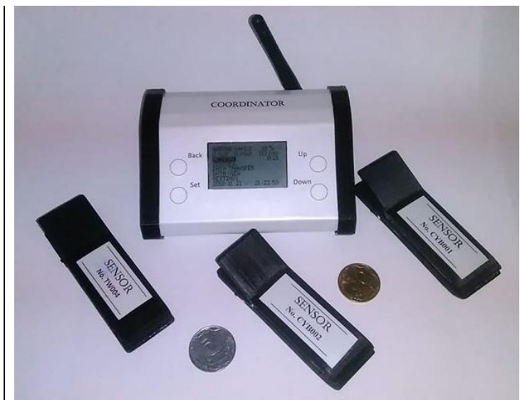
РИС. 3. Дослідний взірець бездротової сенсорної мережі
