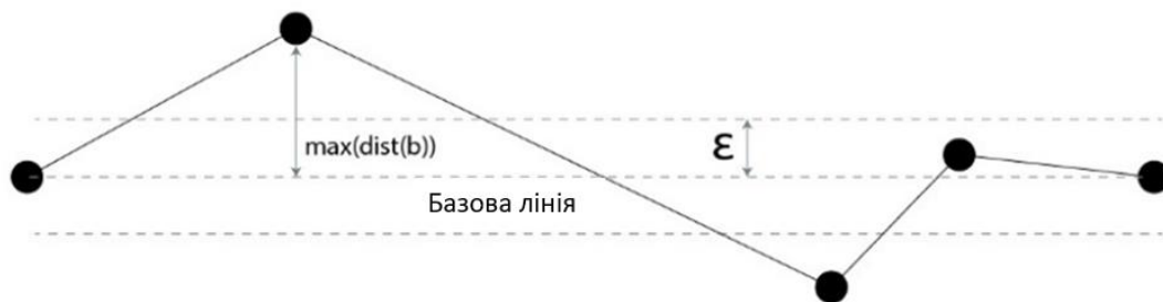
РИС. 9. Згладжування кусково-лінійної кривої алгоритмом Ramer-Douglas-Peucker
