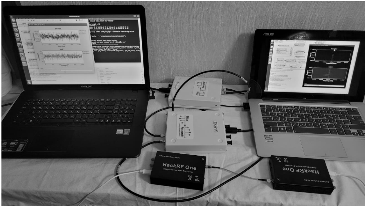
РИСУНОК. Лабораторний стенд для дослідження роботи системи державного впізнання з резервними каналами
