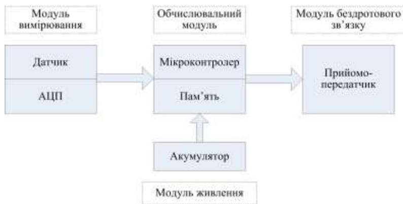
РИС. 1. Архітектура типового бездротового сенсорного вузла
