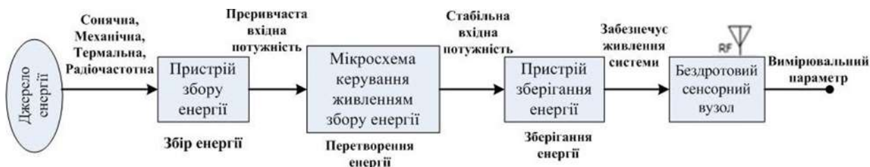
РИС. 3. Функціональна схема Системи збору енергії
