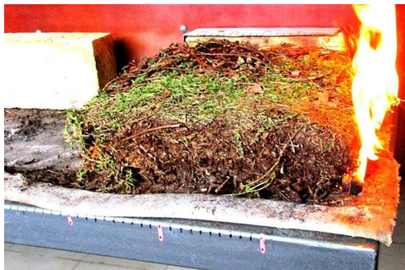
Рис. 2 – Спалювання моноліту підстилки на випробувальному стенді (а) та схема розміщення термопар (б)
