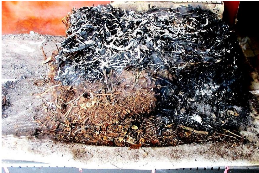
Рис. 4 – Межа проходження фронту тління підстилки
