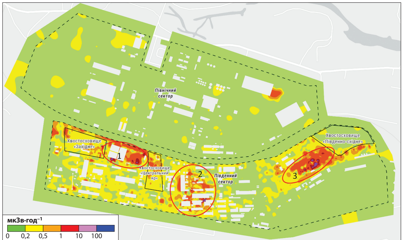
Рис. 2. Карта ПАЕД гамма-випромінювання території колишнього ВО "ПХЗ" (Development of the method ..., 2017) із локацією хвостосховищ "Західне", "Центральний Яр" і "Південно-східне", і основних зон локалізації поверхневого забруднення ґрунтів (1) — седиментаційні відстійники і прилеглі території, (2) — зона розташування основних будівель колишнього уранового виробництва і (3) — територія розвантаження уранових руд для подальшої переробки
