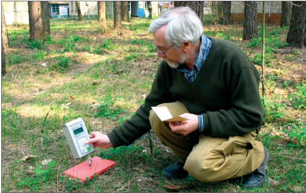
Рис. 4. Вимірювання аероіонів і їх співвідношення іономіром MAC- 01
