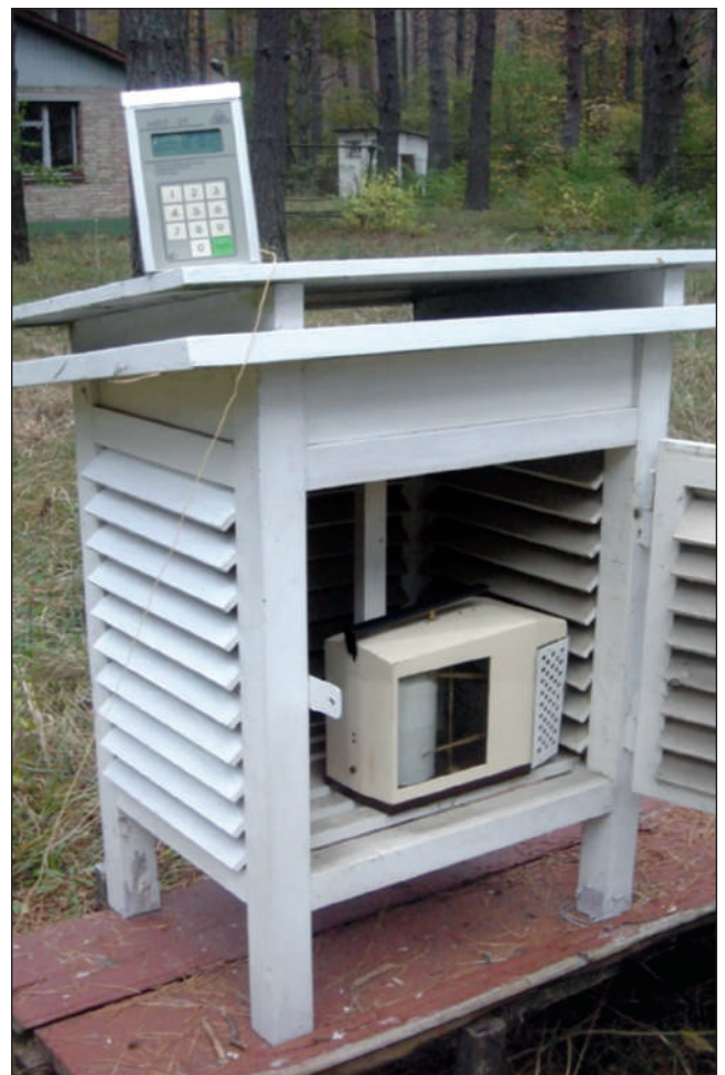
Рис. 3. Метеорологічна будка із механічними тижневими самописцями атмосферного тиску, вологості і температури повітря, а також лічильника аероіонів
