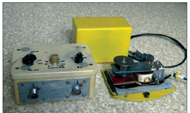
Рис. 5. Сейсмостанція (датчик і адаптер) для фіксації вібраційних і коливальних вертикальних рухів в аномальній і фоновій ділянках на полігоні "Лютіж" (спроектована і виготовлена Чурубровим М.С.)
