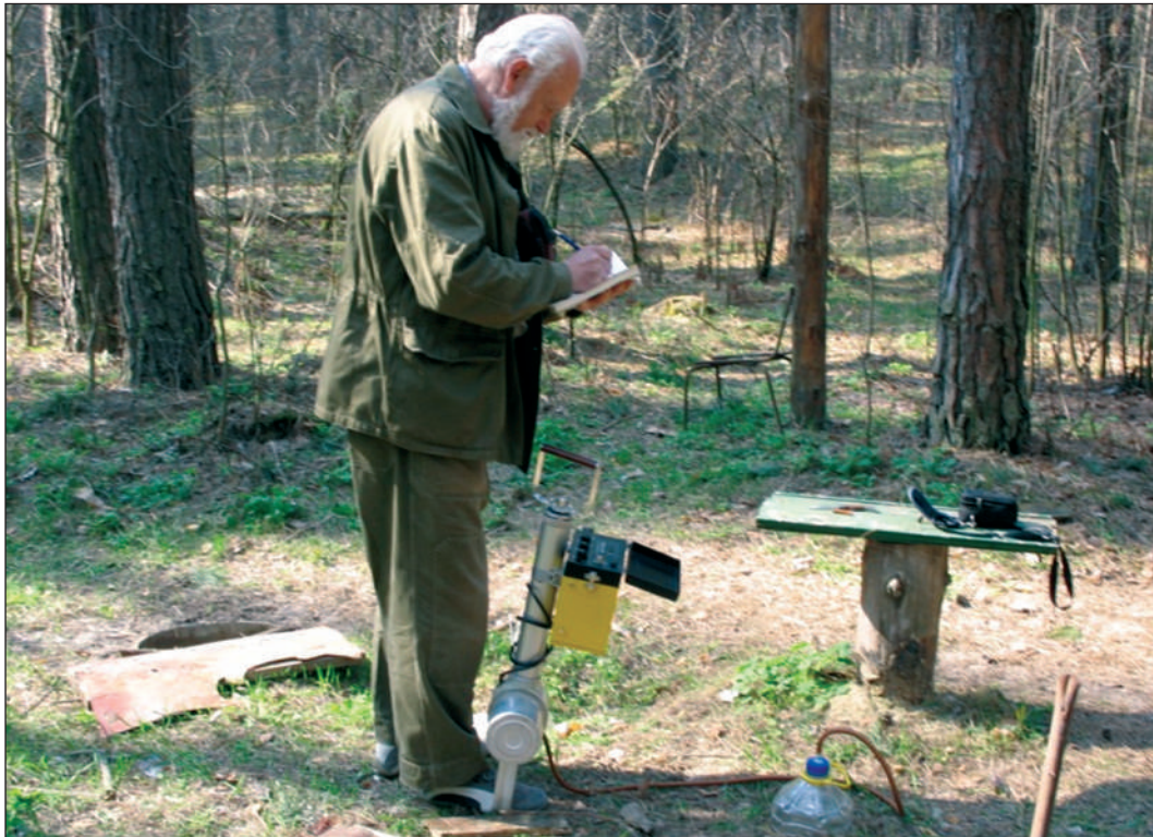
Рис. 6. Вимірювання радону в ґрунтовому повітрі в аномальній зоні і на фоновій ділянці полігону “Лютіж” приладом альфа-бета аналізатор \gamma -спектрометр РГА-01
