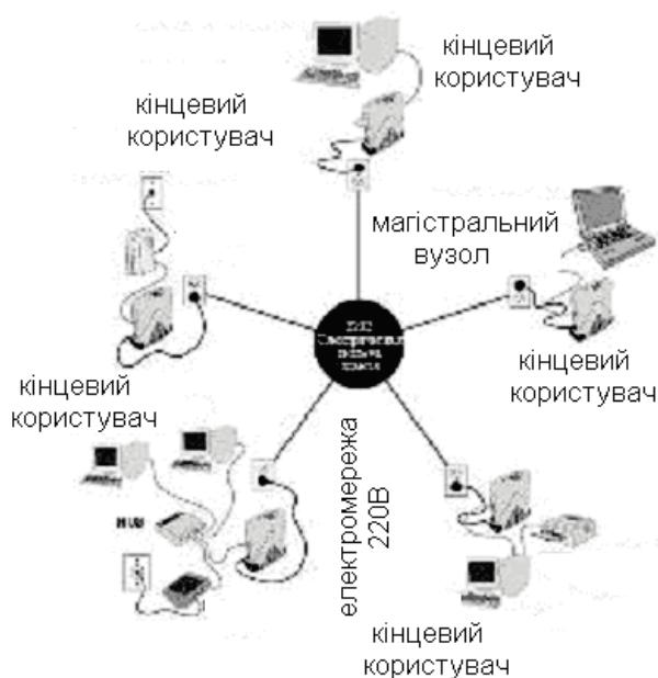
Рис. 2. Магістральний вузол мереж HomePlug, та підключення до нього периферійних пристроїв кінцевих користувачів [12]
