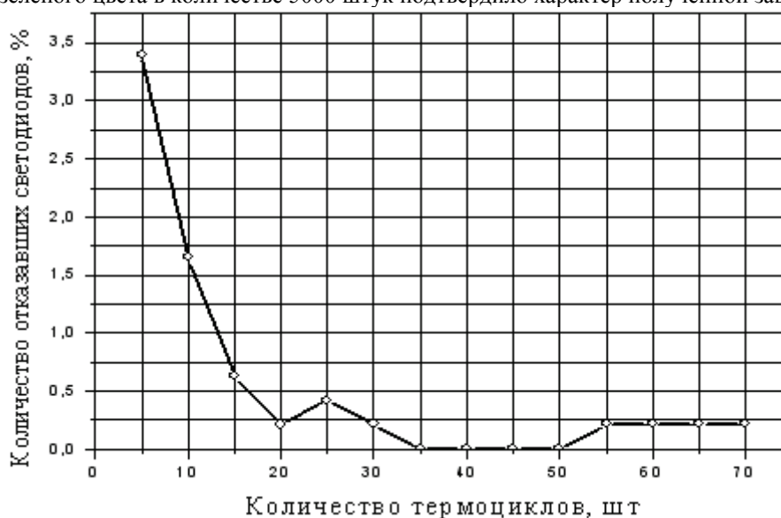
Рис. 1. Залежність кількості відмовившихся зелених світодіодів після проведення процесів їх термоциклірування від кількості термоциклів (ісходна партія діодів в кількості 500 шт.)
