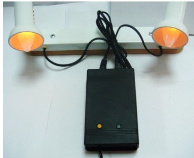
Рис.4.Зовнішній вигляд реалізованої мікроконтролерна система регулювання ламп розжарювання
