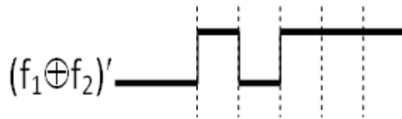
Рис. 4. Результат диференціювання суми за модулем два функцій f_1 та f_2
