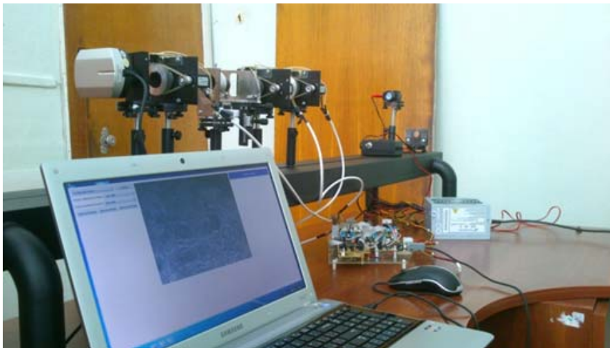
Рис. 2. Зовнішній вигляд експериментальної установки системи Мюллер-матричного картографування
