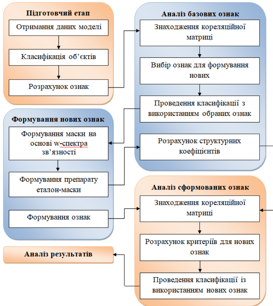
Рисунок 7 – Схема алгоритму роботи системи для оцінювання мікроциркуляції судин ока
