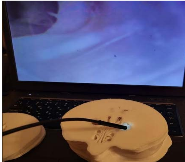
Рисунок 7 – Приклад створення тренінгової системи для опанування навичок ендоскопії на основі прототипування персоніфікованих даних комп'ютерної томографії
