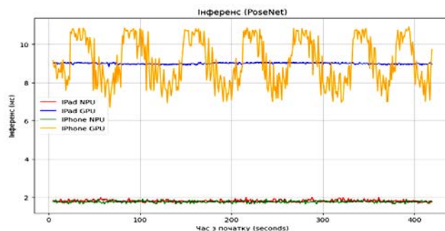
Рисунок 8 – Інференс для PoseNet на GPU девайсів у порівнянні з NPU
