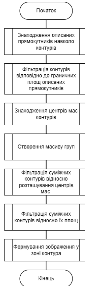
Рисунок 20 – Блок-схема адаптивного алгоритму формування контуру зображення
