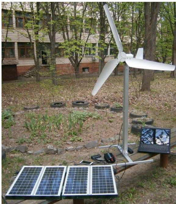
Рис. 16. Мобільна сонячна і комбінована сонячно/вітрова електростанція, призначена для використання у польових (екстремальних) умовах потужністю 20 - 80 Вт.
