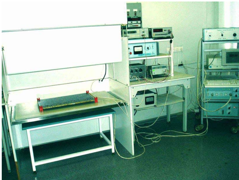
Рис. 18. Стендова база ЦЕНТРУ ВИПРОБУВАНЬ ФОТОПЕРЕТВОРЮВАЧІВ І ФОТОЕЛЕКТРИЧНИХ БАТАРЕЙ для електричних і фототехнічних випробувань БФ космічних апаратів.
