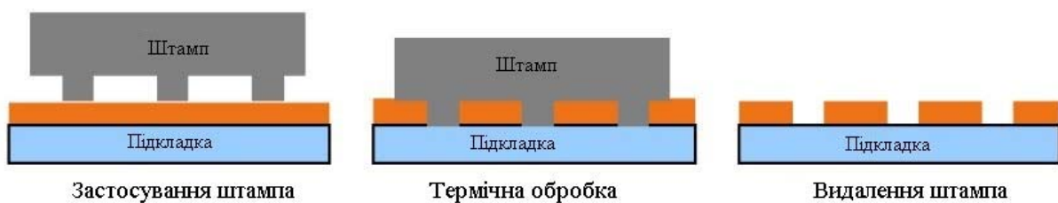
Рис. 12. Схема процесу методу літографії капілярною силою [43].
