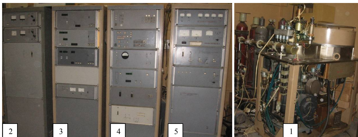
Рис.1. Загальний вигляд установки «Катод - 1М»: 1 – агрегат вакуумний з технологічною камерою; 2 – шафа джерела живлення постійного струму (УВ 40-02); 3 – шафа контролю параметрів (ШКП); 4 – шафа управління (ШУ); 5 – шафа ВЧ- генератора (УВ 70-01).
