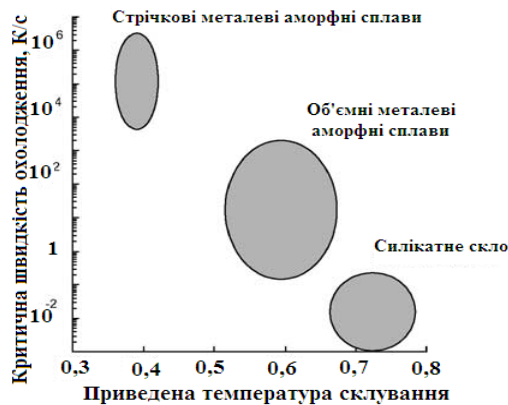
Рис. 2. Діаграма зв'язку температурних меж скловання з критичною швидкістю охолодження розплаву при одержанні аморфних структур
