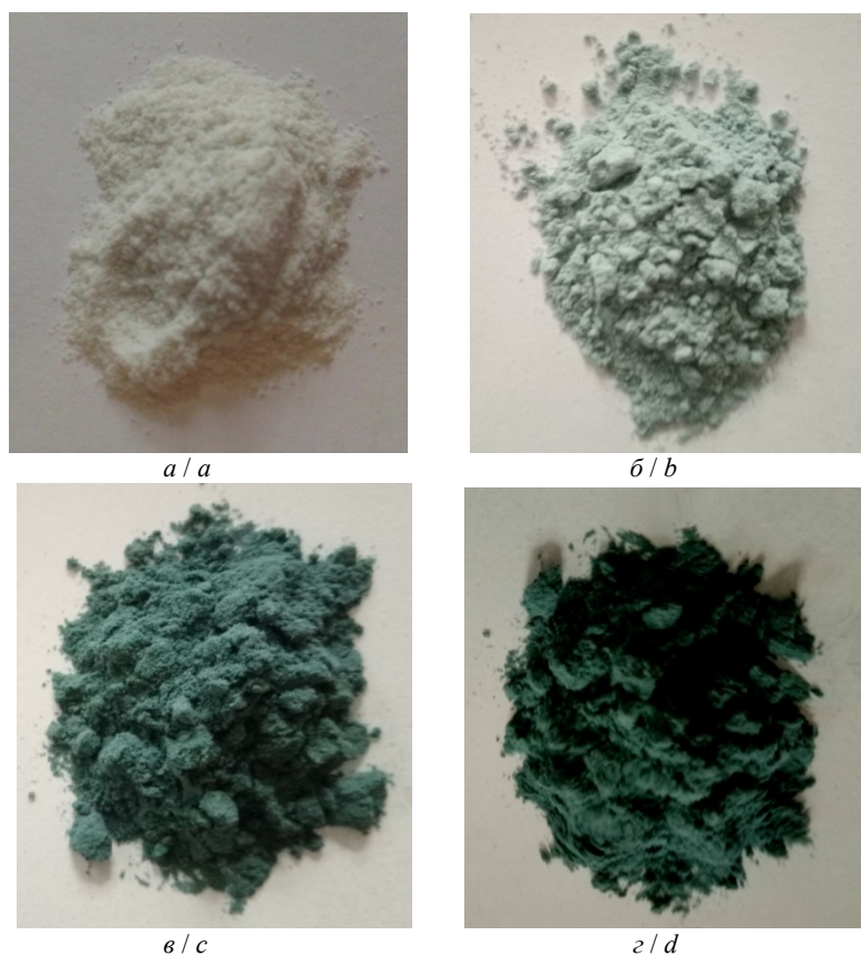
Рис. 1. Візуалізація зміни забарвлення реакційної суміші під час механохімічного синтезу композитів Цл/ПАн, хв після початку синтезу: 0 – a ; 20 – б ; 60 – в ; 24 год – г .
