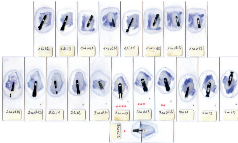
Рисунок 2А. Гістологічні препарати кісткової тканини щелеп піддослідних тварин та ендосальних частин дентальних імплантатів в одній площині зрізу кістково-імплантатного інтерфейсу
