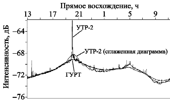
Рис. 17. Суточная зависимость интенсивности радиоизлучения фона Галактики в направлении точки кульминации радиоисточника 3С 405, полученная с помощью западного плеча УТР-2 и субрешетки ГУРТ
