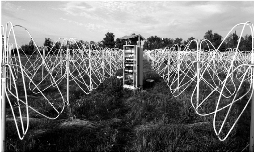
Рис. 19. Субрешетки сверхширокополосного РТ нового поколения ГУРТ
