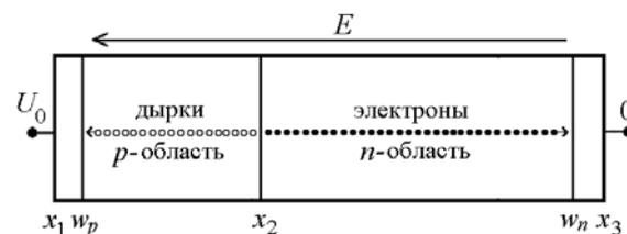
Рис. 1. Упрощенная модель двухпролетного резкого  $p$ - $n$ -перехода ( $U_0 < 0$ )
