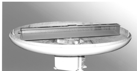
Рис. 7. Щелевая антенна РЛС «Буревестник-2»
