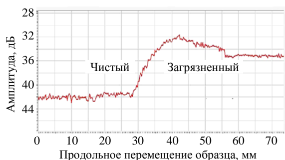
Рис. 8. Зависимость глубины интерференционного минимума при продольном перемещении образца, частично загрязненного кремниевой смазкой
