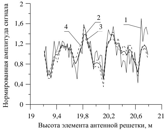
Рис. 4. Зависимость амплитуды сигнала от номера n и высоты центра элементарной приемной антенны вертикальной линейной антенной решетки
