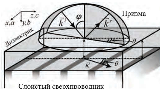
Рис. 7. Конфигурация Отто для возбуждения локализованных волн в образце, слой которого перпендикулярны границе
