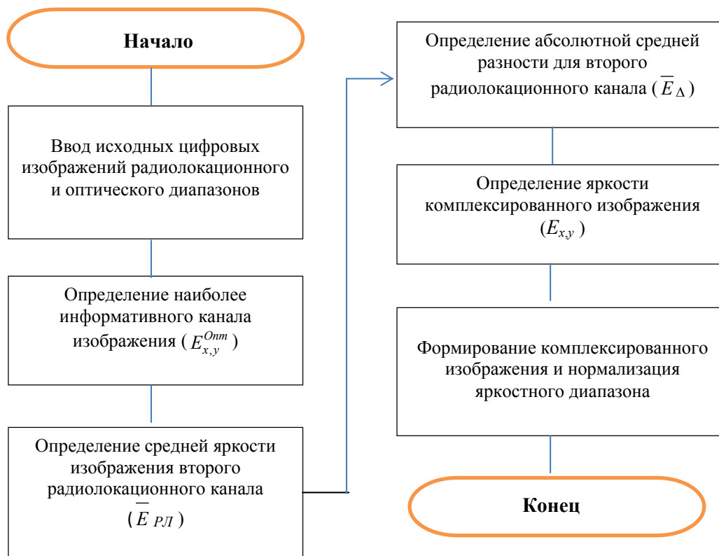
Рис. 5. Блок-схема обобщенного алгоритма комплексирования изображений
