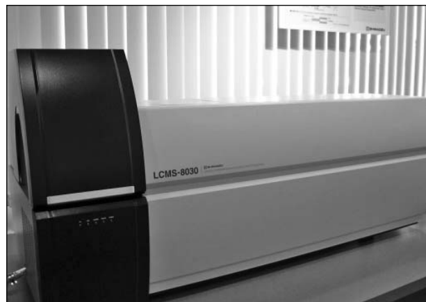
Рис. 8. Высокоскоростной масс-спектрометр с тройным квадруполом SHIMADZU (модель LCMS-8030)
