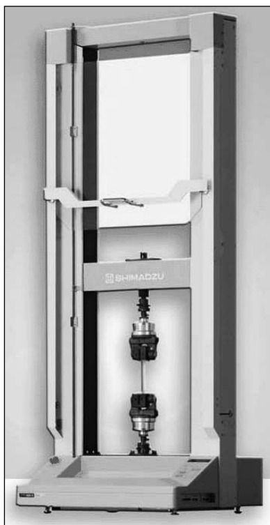
Рис. 14. Испытательная машина SHIMADZU (модель AGS-10kNX)
