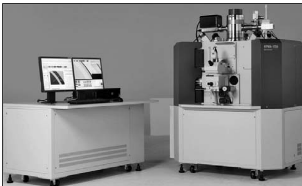
Рис. 3. Электронно-зондовый микроанализатор SHIMADZU (модель EPMA-1720)
