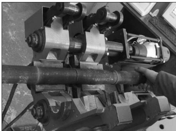
Рис. 3. Установка труб у затискні пристрої зварювальної машини
