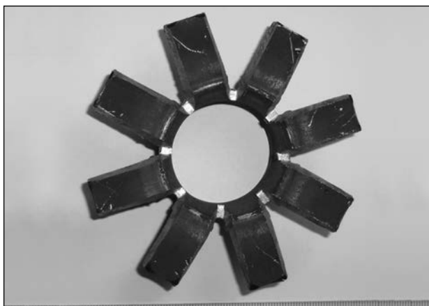
Рис. 6. Результати випробувань на згин зварних з'єднань труб діаметром 42 × 4 мм
