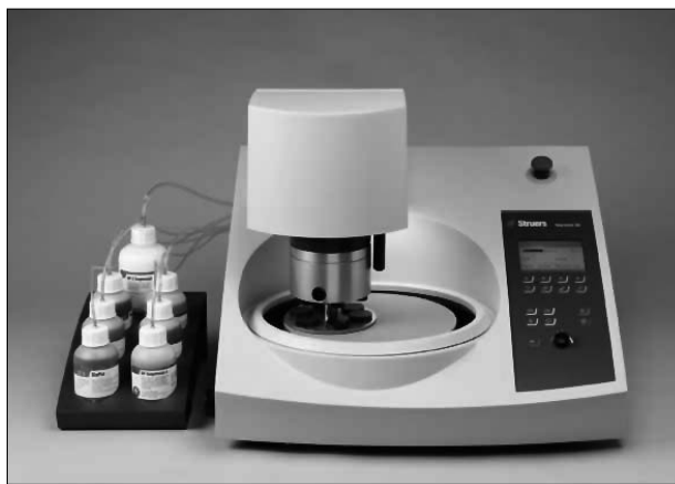
Рис. 2. Автоматический шлифовально-полировальный станок Tegramin-30 (Struers, Дания)
