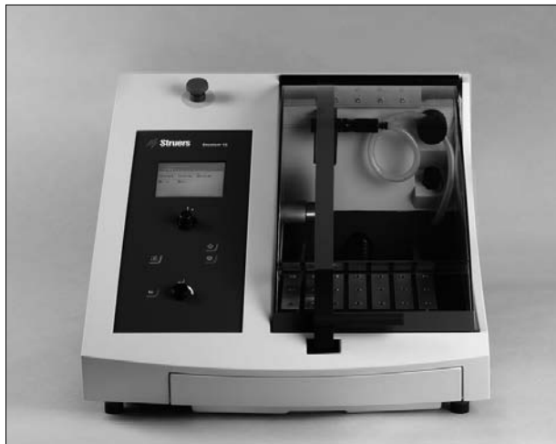
Рис. 1. Прецизионный отрезной станок Secotom-15 (Struers, Дания)
