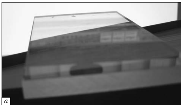
Рис. 1. Механічні напруження та структура загартованого листового скла. Дослідження проведено у відбитому сонячному поляризованому світлі з використанням поляризаційного фільтра на об'єктиві фотокамери. Кут розміщення зразка до напрямку падаючого випромінювання — 160\text{--}180^\circ
