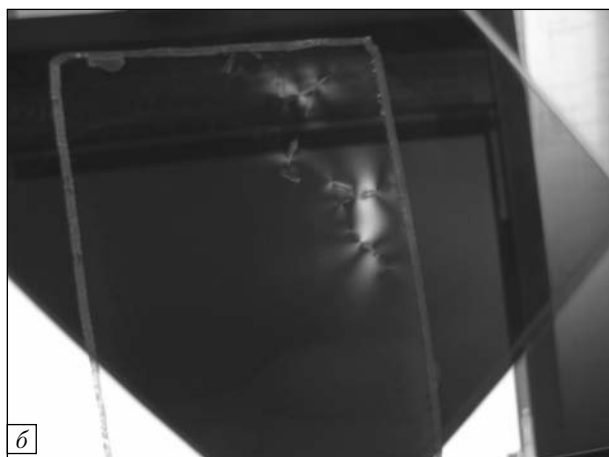
Рис. 3. Виявлені внутрішні механічні напруження в органічному склі СО-120 після деформації (а) та локального руйнування (б)
