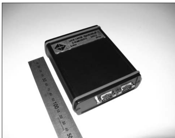
Рис. 4. Внешний вид блока связи удаленного
