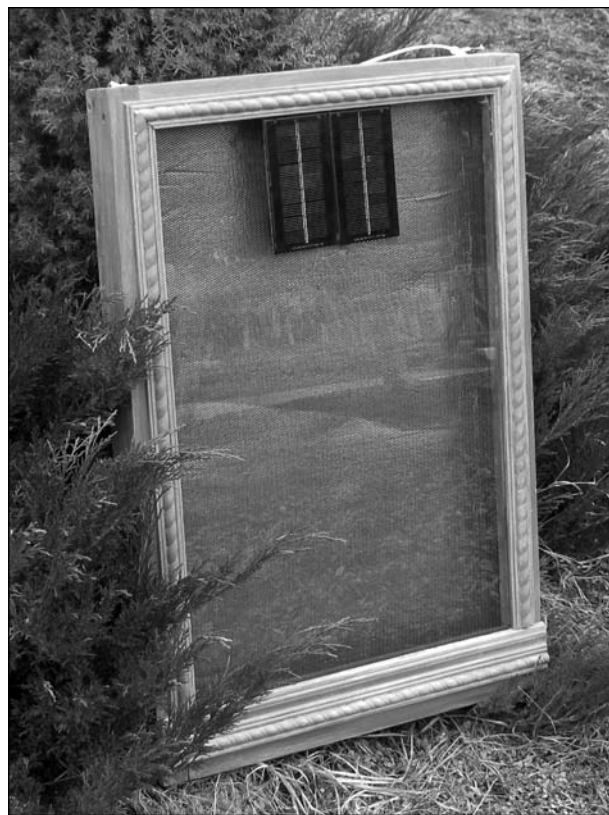
Рис. 2. Загальний вигляд сонячного теплового повітряного колектора
