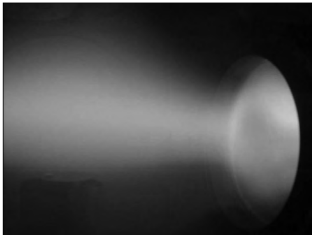
Рис. 3. Потік вуглецевої плазми в джерелі вакуумно-дугової плазми з прямолінійним фільтром мікрочасток
