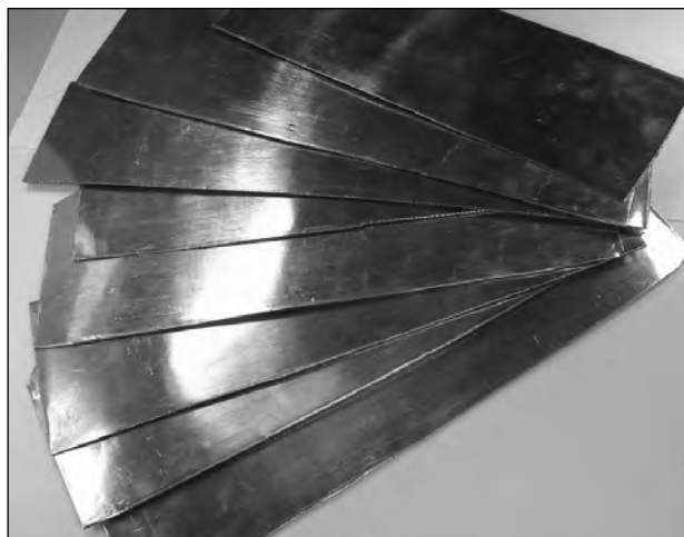
Рис. 8. Смуги РЗ композитів Al–Pb, що входять до складу дослідно-промислової партії
