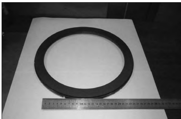
Рис. 4. Кільцеві ущільнення систем СГУ після нанесення алмазоподібного покриття
