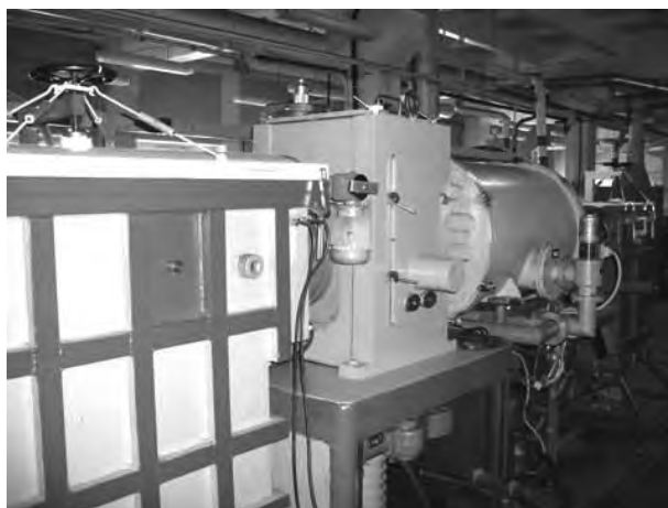
Рис. 6. Вакуумна прокатно-зварювальна установка СВАПР
