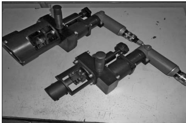
Рис. 8. Загальний вигляд дослідних зразків торцювачів ТРЦ38 УЗ.1 (справа) і ТРЦ76 УЗ.1 (зліва)
