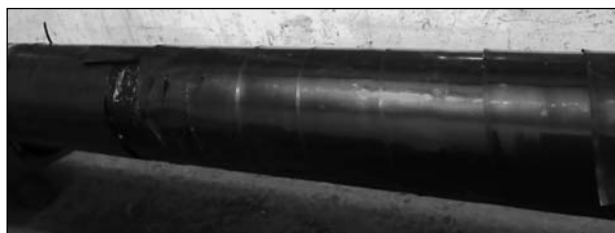
Рис. 3. Зовнішній вигляд покриття на трубі діаметром 325 мм
