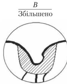
Рис. 7. Впадини плющильного валка з хвилястим опуклим профілем бічної правого виконання
